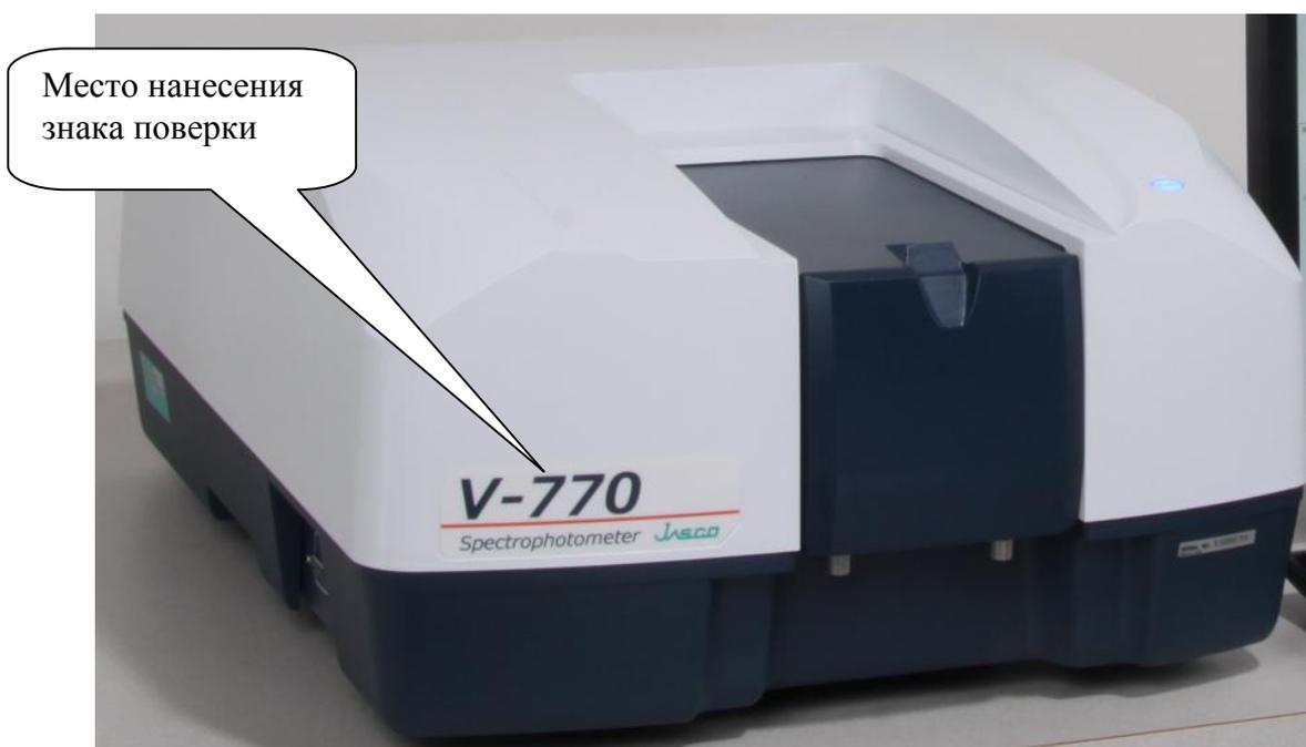
Рисунок 4 - Общий вид спектрофотометра модели V-770
